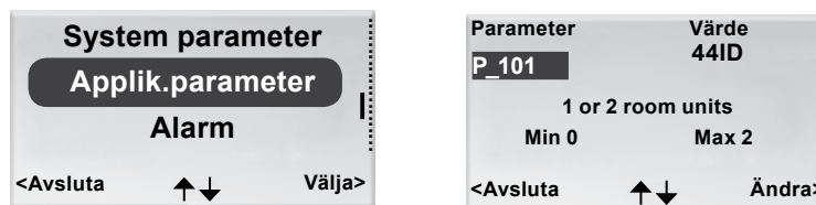
Figur 21. Vy för att välja ändringar av applikationsparametrar samt exempel på vyn parameter.
