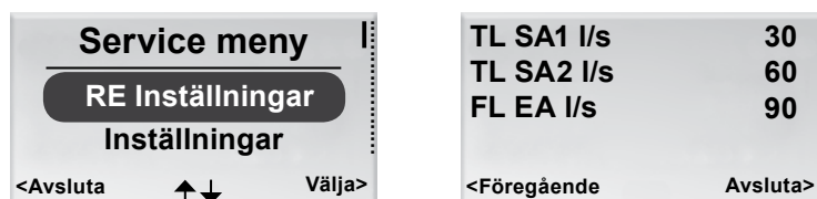
Figur 9. Vy för att välja RE inställningar samt vy för aktuella luftflöden.
