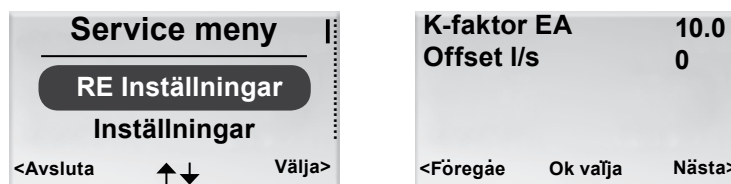
Figur 7. Vy för att välja RE inställningar samt vy för inställning av luftspjäll för frånluft och värde för offset.
