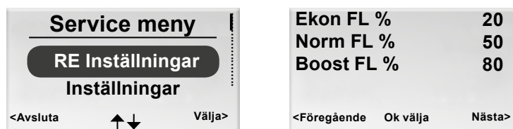
Figur 7. Vy för att välja RE inställningar samt vy för inställning av luftspjäll för frånluft och värde för offset.
