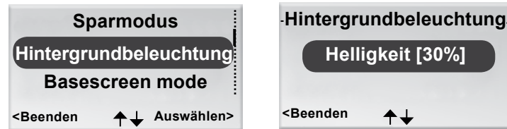
Figur 17. Ansicht zur Auswahl der Hintergrundbeleuchtung sowie Ansicht für die Funktion Hintergrundbeleuchtung.
