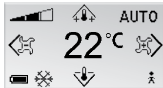
Abb. 6. Hauptansicht im Display der Raumeinheit.
