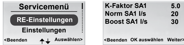
Figur 6. Ansicht zur Auswahl der RE-Einstellungen Ansicht zur Einstellung des K-Faktors und der Zuluftklappe in Luftkanal 1.
