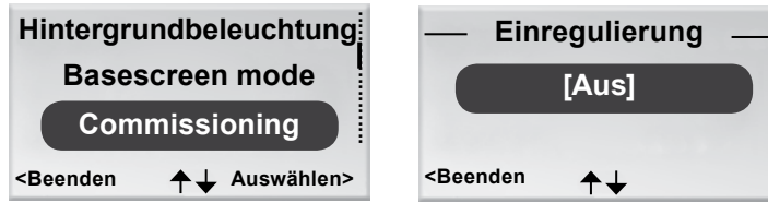
Figur 19. Ansicht zur Auswahl von Commissioning sowie Ansicht für die Funktion Einregulierung.
