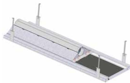
Figur 53. Exempel på upphängning med montageband
