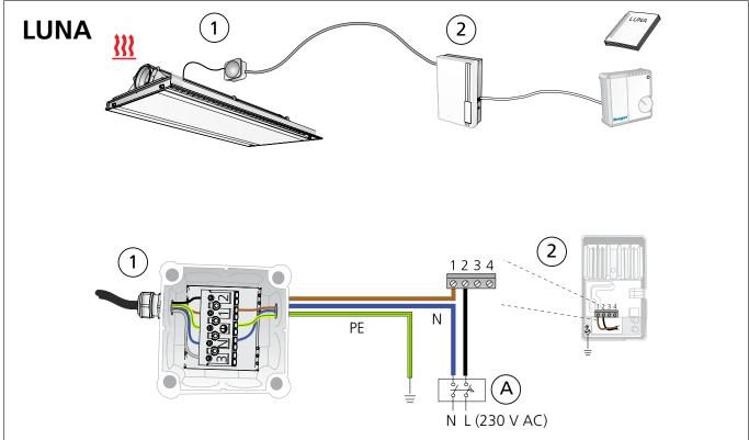
A: Allpolig brytare, brytavstånd >3mm; A: Double-pole switch, contact separation >3mm
