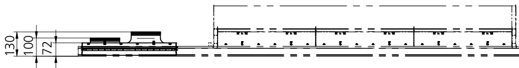
Abbildung 65. PACIFIC SA/EA, Seitenansicht mit Leistungsmodul in Rechtsausführung.
