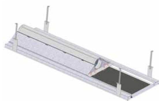
Abbildung 53. Beispiel einer Aufhängung mit Montageband.
