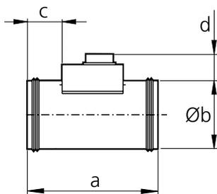
Abbildung 25. Klappe SYST CRPc 9-125
