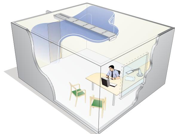
Abbildung 7. Beispiel für eine verschobene Luftverteilung mit VariFlow
