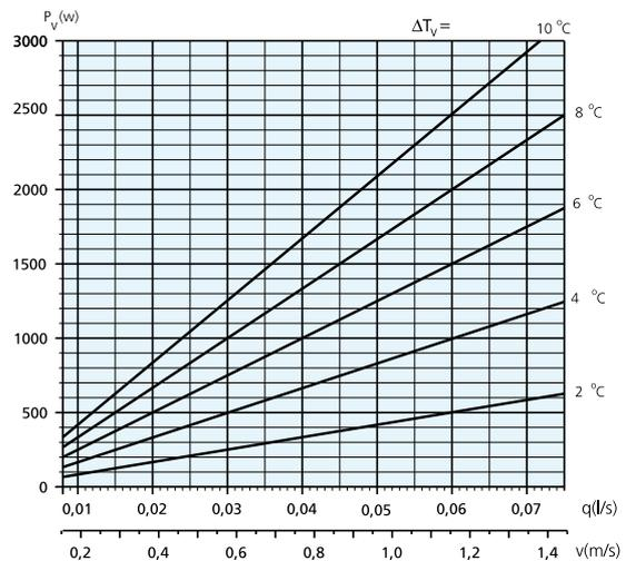
**Diagramm 6. Wasserfluss - Leistungskorrektur, Heizung**
