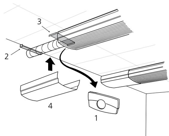
Abbildung 12. Abdeckung für den Anschluss an die Wand
