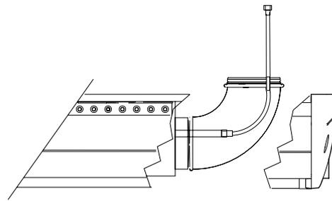
Abbildung 10. Integrierter senkrechter Anschluss, Kanalbogen und Schlauch werden separat bestellt
