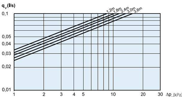
**Diagramm 5. Volumenstrom Wasser - Heizleistung**
