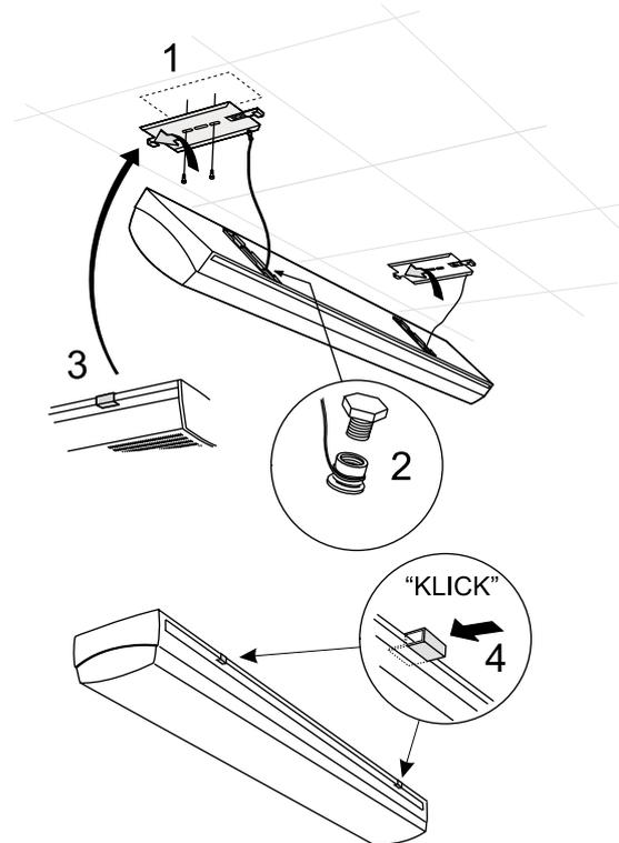
Abbildung 11. Montage dicht unter der Decke, MD4S
