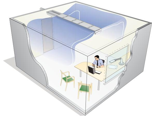
Abbildung 5. Beispiel für eine symmetrische Luftverteilung mit VariFlow
