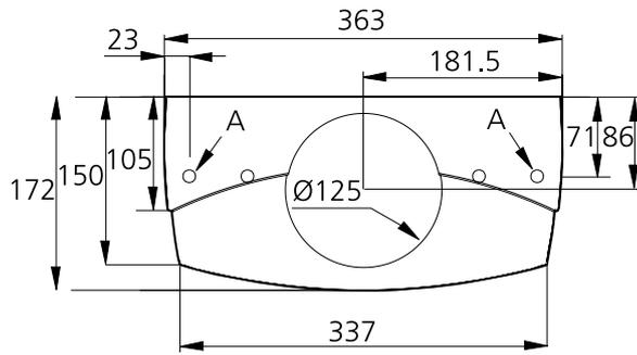
Abbildung 16. Kanalanschluss 125 mm, von der Stirnseite aus gesehen.
