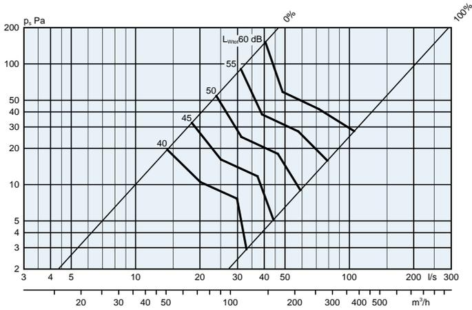
**Tabelle 17. Schallleistungspegel Klappe CRPc 9-125, Korrekturfaktor,  $K_{ok}$**
