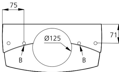
Abbildung 17. Kanalanschluss 125 mm, von der Stirnseite aus gesehen
