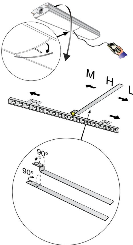
Abbildung 13. Änderung der Düsenkonfiguration mit Hilfe des Einregulierungswerkzeugs
