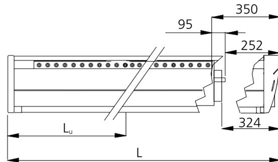
Abbildung 20. Anschluss innen (-I), von der Längsseite aus gesehen
