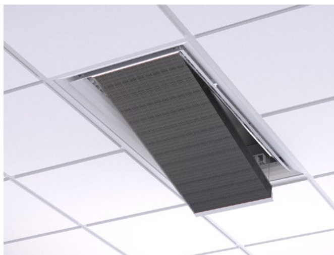
Figur 15. Demontering av underplåt samt fällning av batteri för noggrann rengöring vid höga hygienkrav. Obs! kräver att produkten beställs med tillbehöret, fällbart batteri, samt att flexibla anslutningsslangar används på vattensidan.
