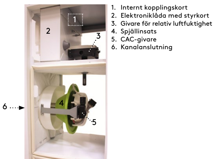
Fig 24. Invändiga komponenter ADAPT Box.
