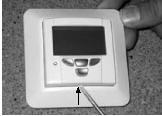
Paneelin irrottaminen ILTO Premium -säätimestä.
