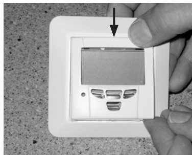
Infästning av panelens lock på Premium-kontrollpanelen. Sätt först lockets övre kant på plats och tryck sedan fast locket.
