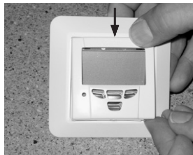
Festing av panelets lokk på Premium-kontrollpanelet. Sett først lokkets øvre kant på plass og trykk deretter fast lokket.
