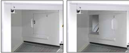
Bypass forbi varmeveksleren: luken er lukket om vinteren, åpen om sommeren.
