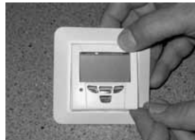
Paneelin kannen kiinnitys Premium-säätimeen. Aseta ensin kannen yläreuna paikalleen ja paina sitten kansi kiinni.
