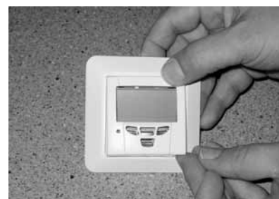
Befestigung der Abdeckung an der Premium-Bedieneinheit. Zuerst die Oberkante einpassen und die Abdeckung danach festdrücken.
