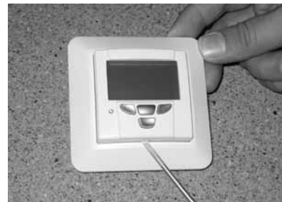
Lösen der Abdeckung an der Premium-Bedieneinheit.
