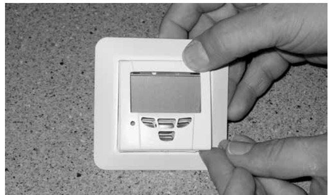
Befestigung der Abdeckung an der Premium-Bedieneinheit. Zuerst die Oberkante einpassen und die Abdeckung danach festdrücken.
