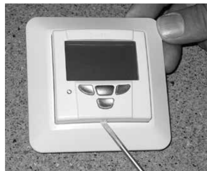
Demontage der Frontplatte einer Premium-Bedieneinheit.
