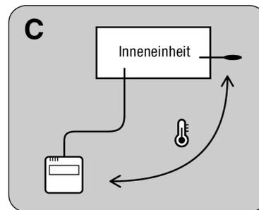
4. Zur freien Auswahl der Temperaturerfassung durch den Bediener drücken Sie die „Thermo-Sensor“-Taste mindestens 5 Sekunden.
