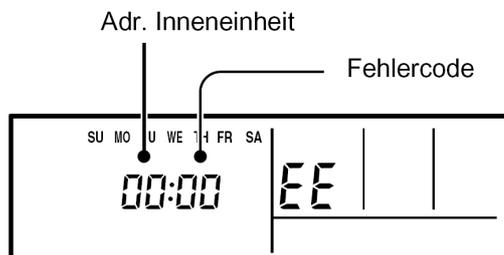
3. Mit der „SET TEMP.“-Taste  $\nabla$  oder  $\blacktriangle$  können Sie die vorliegenden Fehlercode anzeigen.
