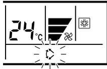
Die Taste für vertikale Luftstromrichtung und Schwenkbetrieb drücken.
