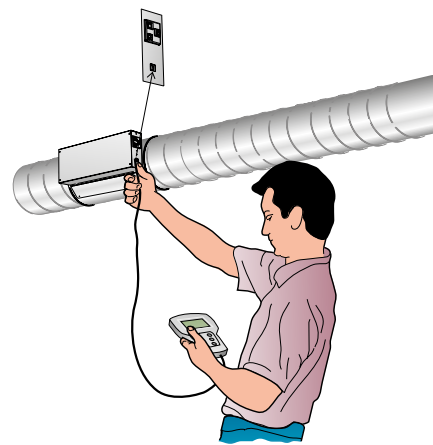
Figur 5. Inkoppling av TUNE Adapt för kontroll och ändring av börvärden. Inkoppling sker direkt i sidan på spjället eller i kopplingsdosan till förlängningskabeln. Om DETECT SME är installerad ansluts TUNE Adapt i denna. Vid anslutning av TUNE Adapt bryts kommunikationen till överordnat system.
