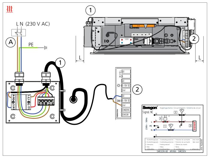
A: Allpolig brytare, brytavstånd >3mm; A: Double-pole switch, contact separation >3mm L: Min. avstånd till vägg >0,4m; Min. distance to the wall > 0.4m
