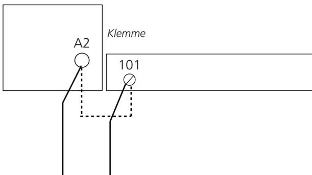
Ein Thermoschalter wird an Schütz A2 und Klemme 101 angeschlossen.
