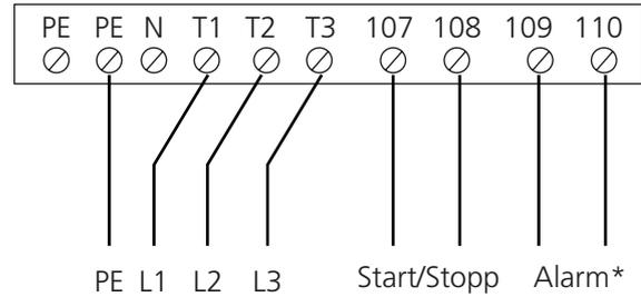
\* schließender/unterbrechender Alarm und Pumpe mit konstanter Drehzahl müssen im Handterminal des GOLD-Geräts eingestellt werden.
