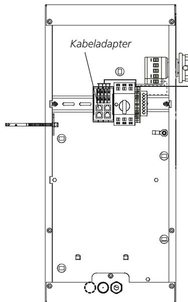
Paarweise verdrehte Kommunikationskabel mit A min. 4 x 0,5 mm<sup>2</sup>, max. 100 Meter (im Lieferumfang nicht enthalten).
