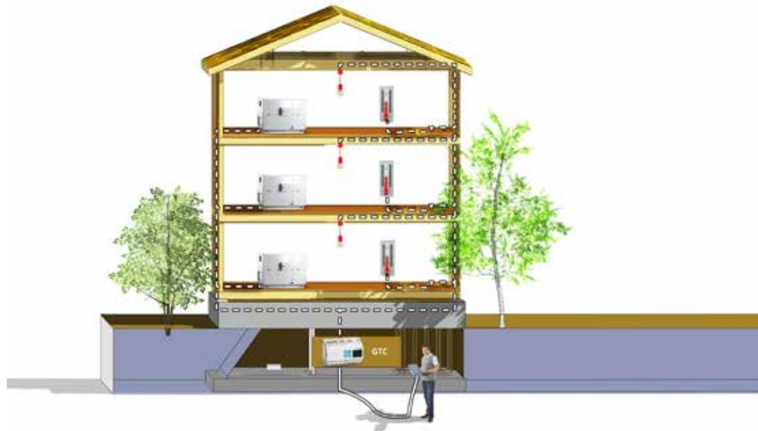
Die in die GLOBAL-Geräte integrierten TAC5-Regelungen bieten die Möglichkeit, mittels MODBUS zu kommunizieren. Dadurch können die Geräte vernetzt werden.
