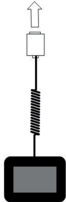
**Elektrisches Kabel:** Installateure müssen zusätzliche elektrische Kabellängen einplanen, um die zukünftige Wartung des RLT-Geräts zu erleichtern.
