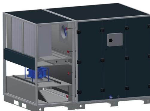
3. Ziehen Sie die Schraube der Verbindungsstücke mithilfe eines Sechskantschlüssels fest (4 vorne, 4 hinten). Das Werkzeug lässt sich durch ein Loch im Rahmen einführen.
