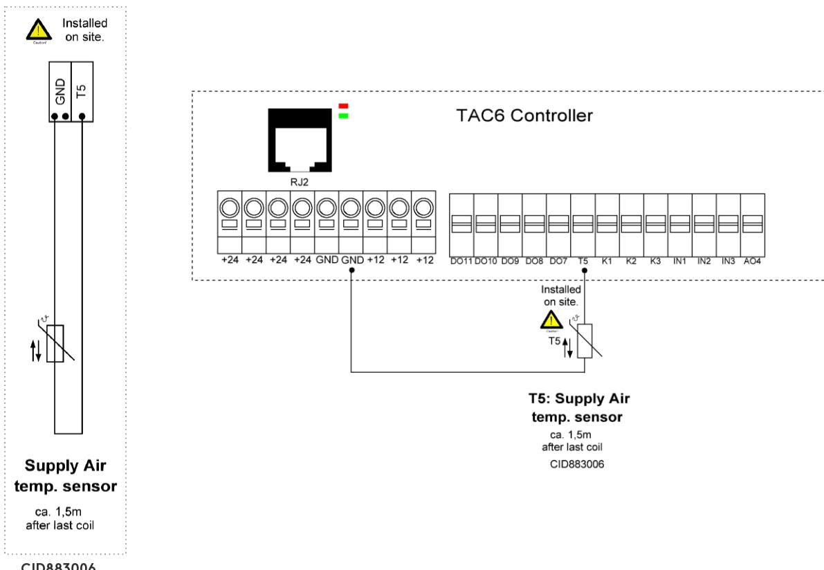
**FR** - La sonde T°5 doit être placée dans le gainage de pulsion (en aval des batteries optionnelles s'il y en a)
