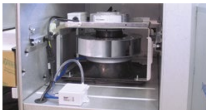
Direktangetriebene Ventilatoren mit EC-Motoren.
