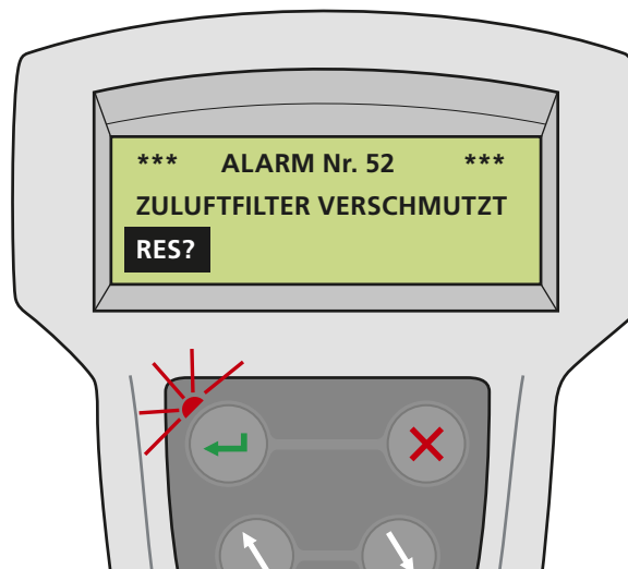
Beispiel eines Menübilds für einen Filteralarm.
