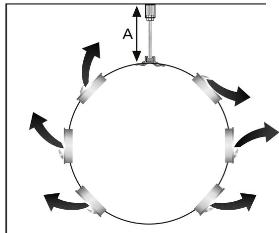
Abbildung 7: 1-Weg-Verteilung zur Wand. Die oberste Düsenreihe des Kanals, die zum Raum zeigt, muss nach unten ausgerichtet sein, alle anderen nach oben.
