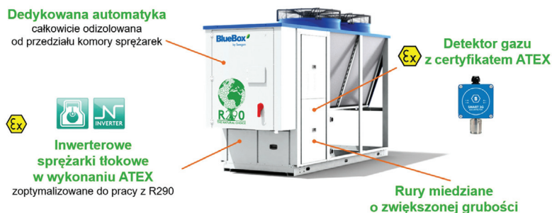
Rys. 4. Wielopoziomowe systemy bezpieczeństwa pompy ciepła TITAN SKY
