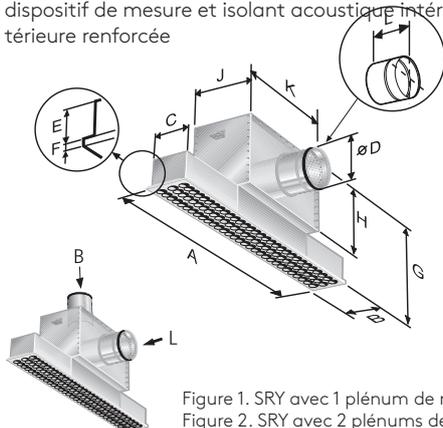
Figure 1. SRY avec 1 plenum de raccordement. B = Connexion par l'arrière. L = Connexion par le côté le plus long.
