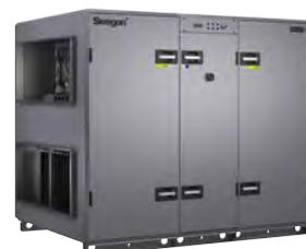
Les centrales simple module GOLD RX/PX/CX sont des appareils complets de traitement d'air avec ventilateurs de soufflage et d'extraction à entraînement direct, filtres au soufflage et à l'extraction et échangeur de chaleur. Les échangeurs de chaleur sont de type rotatif (RX), à plaques (PX) ou composés de deux batteries (CX).
