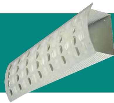
Diffuseur rectangulaire prévu pour être installé directement sur une gaine circulaire ou rectangulaire. La face avant est pourvue d'un certain nombre de déflecteurs de forme aérodynamique. Une grille déflectrice placée à l'arrière de la face avant permet de répartir le débit d'air sur l'intégralité du diffuseur. L'appareil est proposé avec deux, trois ou quatre rangées de déflecteurs.
