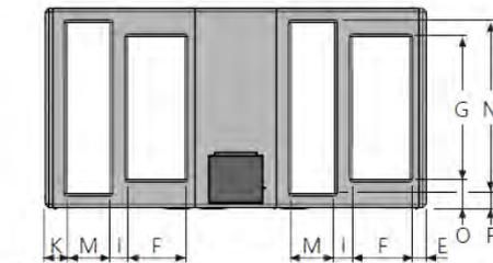
Vue d'en haut. Montre les connexions de la centrale pour le ventilateur d'air soufflé, droit (en haut) et gauche (en bas)
