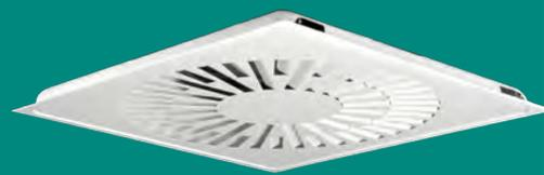
Le diffuseur plafonnier carré SWIFT se compose d'un plenum et d'une façade. Les perforations sont conçues de manière à produire des débits élevés. La façade est fixée par des charnières et des ressorts. Ce système de fixation Quick Access facilite l'ouverture et la fermeture de l'appareil lors de l'installation, l'équilibrage et le nettoyage.
