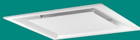
Le diffuseur plafonnier KITE Ceiling se compose d'un caisson et d'une façade pleine. Grâce à son dispositif Easy Access, la façade, fixée par des charnières et des ressorts sur un seul côté, facilite l'accès lors de l'installation, de l'équilibrage et du nettoyage. Le diffuseur existe également en version compacte, lorsqu'il n'y a que peu d'espace d'installation au-dessus du faux-plafond.
