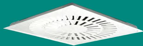
Le diffuseur se compose d'un caisson et d'une façade. Celle-ci dispose de buses rectangulaires en plastique fournissant des débits élevés. Les buses peuvent être facilement repositionnées, en version standard, trois voies ou en diffusion verticale. Le plénum d'équilibrage est orientable à 360°, ce qui facilite l'installation des conduits et évite de devoir utiliser des gaines flexibles.
