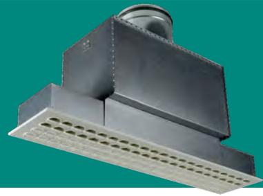
Grille de soufflage linéaire avec buses, constituée de deux parties : la partie diffuseur et le plenum du diffuseur. La partie diffuseur est démontable et dotée de buses de forme aérodynamique. Elle est fixée au moyen de vis sur le plenum dans lequel se trouve une plaque de répartition perforée.
