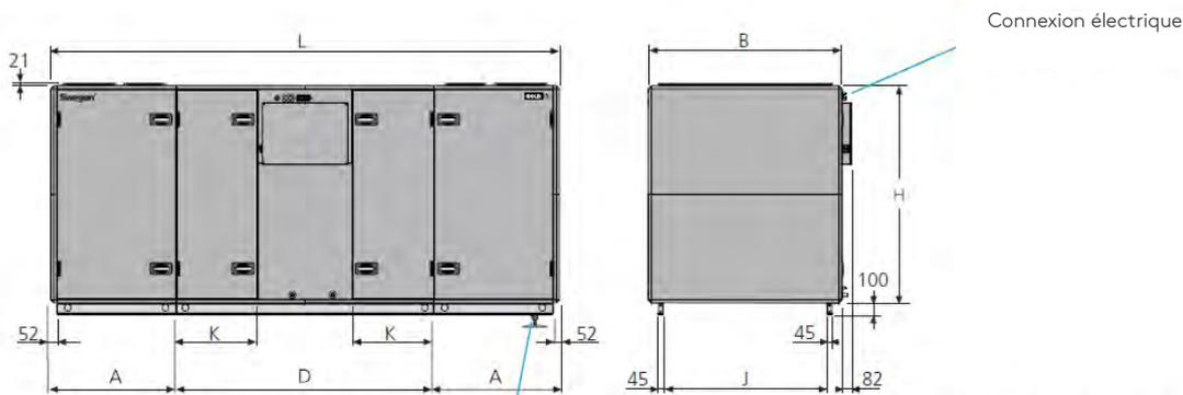
Si un siphon est installé (accessoire), il faut prévoir un dégagement : la centrale de traitement d'air doit être surélevée d'au moins 50 mm. Les pieds (accessoires) peuvent servir à cet effet.
