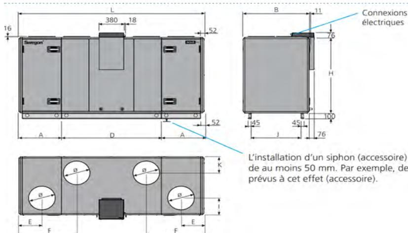
L'installation d'un siphon (accessoire) impose de surélever la centrale de au moins 50 mm. Par exemple, des pieds de support peuvent être prévus à cet effet (accessoire).
