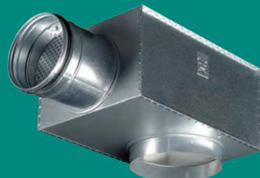
Le plénum d'équilibrage ALS est réalisé en tôle d'acier galvanisé et est revêtu d'un isolant interne acoustique\* à surface renforcée. Il possède un registre d'équilibrage amovible qu'on peut retirer pour nettoyer la gaine.
