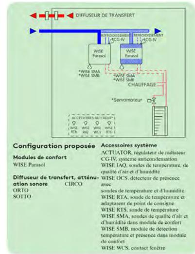
Solution bureau consistant en au moins un module de confort actif avec débit d'air variable + air transféré. La détection de présence et la mesure de température se font au niveau du module de confort actif. Ce dernier régule le débit d'air soufflé ainsi que le refroidissement et/ou le chauffage, de manière à assurer la climatisation voulue. Air extrait vers le couloir (avec extraction centralisée) via un diffuseur de transfert silencieux.
