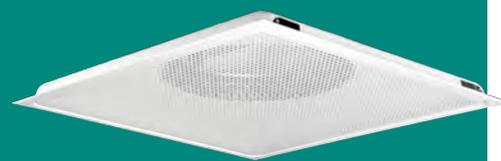
De format carré, le diffuseur d'air extrait haut débit PELICAN se compose d'un plenum et d'une façade perforée. La façade est fixée au plenum par des charnières d'un côté, et retenue par des ressorts de l'autre. Ce système de fixation Quick Access permet une ouverture et une fermeture rapides lors de l'installation, de l'équilibrage et du nettoyage.
