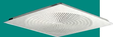
Diffuseur plafonnier composé de deux parties : un plenum et une façade. La façade présente des perforations disposées en cercle pour créer un tourbillon. Un de ses côtés est équipé de charnières ; l'autre est muni de ressorts assurant la fermeture. Ce mode de fixation, appelé Quick Access, permet d'ouvrir et fermer rapidement le panneau du diffuseur pour faciliter l'installation, la mise en service et l'entretien.
