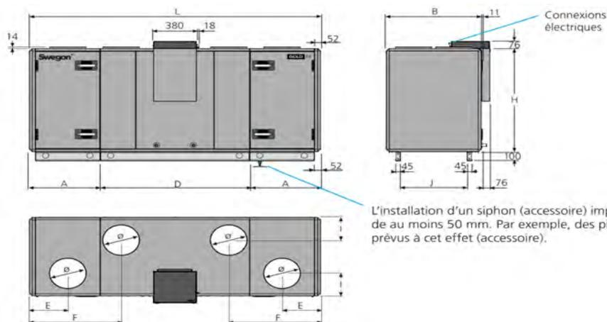
L'installation d'un siphon (accessoire) impose de surélever la centrale de au moins 50 mm. Par exemple, des pieds de support peuvent être prévus à cet effet (accessoire).
