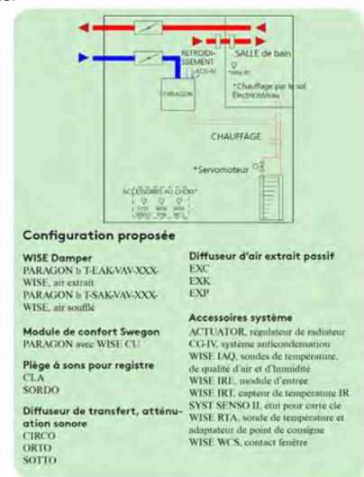
Solution pour chambre d'hôtel. La pièce bénéficie d'un débit d'air soufflé et d'air extrait variables (pression équilibrée par registre au niveau de l'air soufflé et de l'air extrait). La régulation du module de confort actif assure une arrivée d'air correcte dans la pièce ainsi que le refroidissement et/ou le chauffage, de manière à assurer la climatisation voulue. Air extrait via registre d'extraction distinct et diffuseur d'air extrait passif dans la salle de bain.
