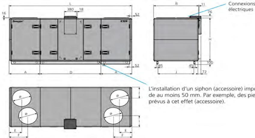
L'installation d'un siphon (accessoire) impose de surélever la centrale de au moins 50 mm. Par exemple, des pieds de support peuvent être prévus à cet effet (accessoire).
