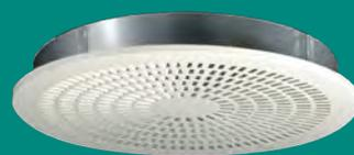
Bouche circulaire perforée pour le soufflage et la reprise composée de deux parties : la partie diffuseur et le plenum. Suspendue à des clips et dotée d'une garniture en caoutchouc, la partie diffuseur est démontable et présente des perforations directrices placées selon un motif circulaire. Le boîtier du diffuseur est également doté d'une garniture en caoutchouc.
