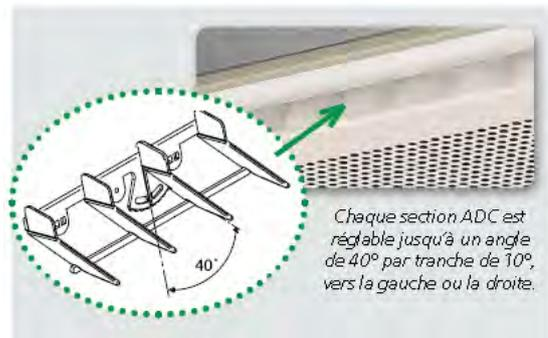
Chaque section ADC est réglable jusqu'à un angle de 40° par tranche de 10°, vers la gauche ou la droite.
