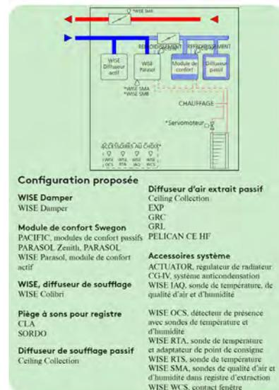
Solution pour bureau ouvert consistant à minima d'un module de confort actif et d'un diffuseur d'air soufflé ou registre actif.
