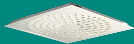
Le diffuseur plafonnier se compose d'un plenum et d'une façade. La façade est équipée de disques aérodynamiques orientables. Elle est fixée par des charnières et des ressorts. Le système de fixation Quick Access facilite l'ouverture et la fermeture de l'appareil lors de l'installation, la mise en service et le nettoyage.
