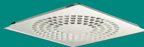
Le diffuseur plafonnier se compose d'un plenum et d'une façade. Les perforations sont conçues de manière à produire des débits élevés. La façade est fixée par des charnières et des ressorts. Ce système de fixation Quick Access facilite l'ouverture et la fermeture de l'appareil lors de l'installation, l'équilibrage et le nettoyage.
