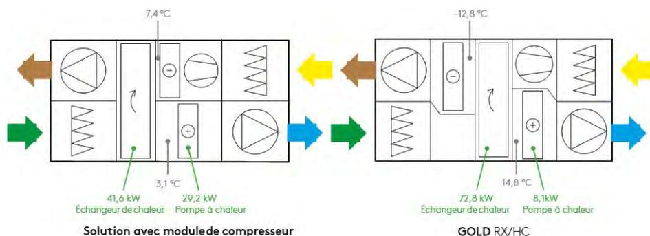
Les deux schémas montrent que les solutions à module compresseur doivent largement chauffer l'air soufflé via la pompe à chaleur. A contrario, avec la GOLD RX / HC, l'échangeur de chaleur rotatif répond aux besoins énergétiques en récupérant l'énergie de chauffage de l'air extrait, qui est en soi de l'énergie électrique gratuite. La pompe à chaleur peut ensuite faire l'appoint pour la partie manquante des besoins de chauffage.
