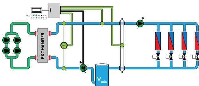
Automatische Regelung des variablen Volumenstroms einschließlich Abgleich des Volumenstroms zwischen Primär- und Sekundärseite. Die Strategie zur Regelung des Volumenstroms im Primärkreis basiert auf der Differenztemperatur zwischen  $T_{out}$  und der Weiche, um die Geschwindigkeit der Primärpumpe anzupassen.
