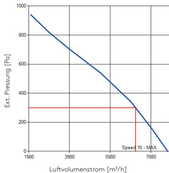
Abb. 4 Ventilatorcharakteristik LKM
