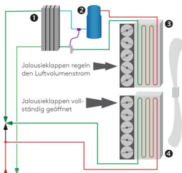
Schema: Vollständige Kühlung über das Freikühlregister
