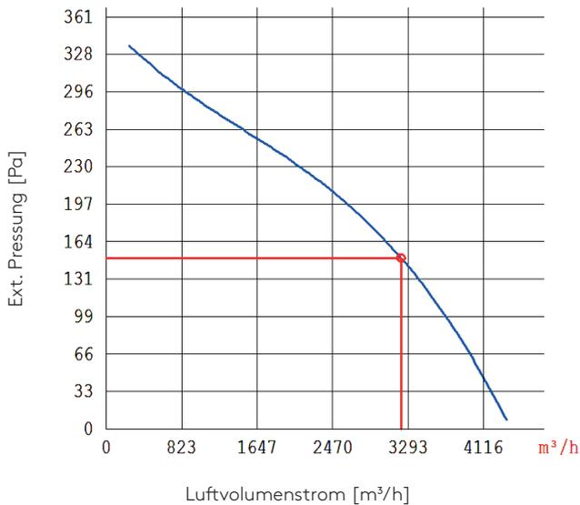
Abb. 2 Ventilatorcharakteristik LKS
