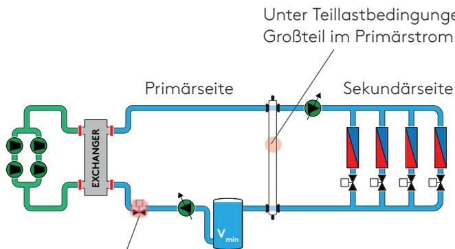
Die Durchflussregelung durch ein Strangreguliertventil erzeugt zusätzlichen Druckverlust und dadurch einen höheren Energiebedarf.
