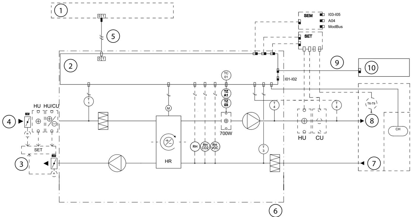
1: Gruppenzentrale | 2: Schaltschrank | 3: Fortluft | 4: Außenluft | 5: Stromversorgung: 230 V, 10 A mit Steckanschluss | 6: Kennzeichnung des Zuluftteils des Lüftungsgeräts | 7: Abluft | 8: Zuluft | 9: Modularkabel mit RJ9-Kontakten | 10: Bedieneinheit
