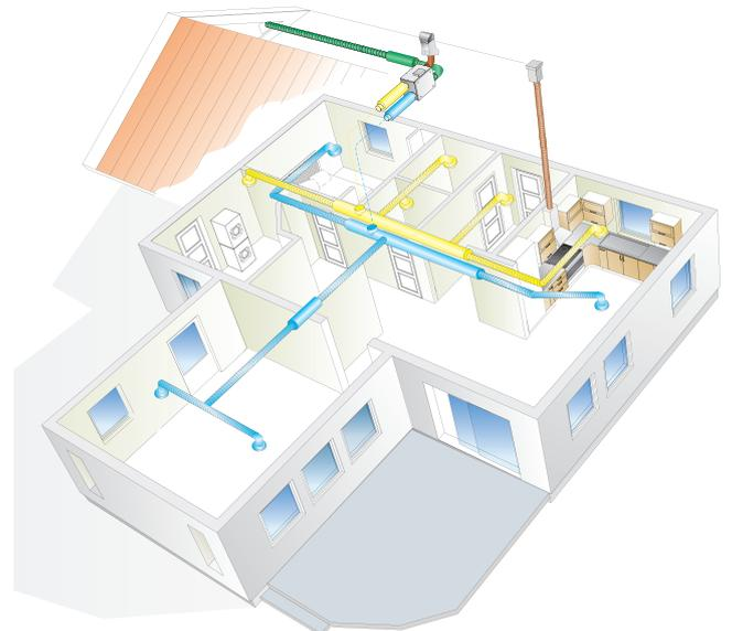
Raccordements aérauliques sur R5-H L
