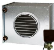
Dans un bâtiment chauffé par circuit d'eau, l'air soufflé peut être réchauffé à l'aide d'une batterie de chauffage eau à montage sur gaine. La batterie de chauffage est pilotée automatiquement par le système de régulation intelligente du module de ventilation, et on peut modifier le paramétrage à l'aide d'un panneau de commande CASA Smart. Inclus à la livraison: Batterie de chauffage, module de connexion SET, servomoteur et vanne 3 voies, transformateur 24 V, capteurs et mode d'emploi.
