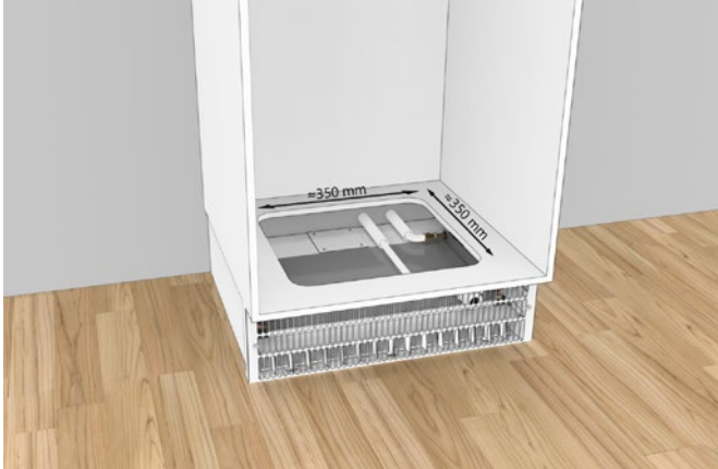
Kuva 20. Asennettu tuote kaapin sokkelissa, jossa alempi pohja-levy on sahattu pois siivoamisen helpottamiseksi.
