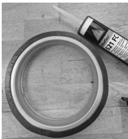
5. Montera en packningslist samt lim/kit på påsticket
