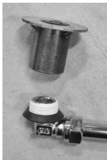
7. Montera ihop "svartmuff med bricka", "stor gummipackning", "½" 90° vinkel" samt "12 mm rör". Lägg på gängtejp
