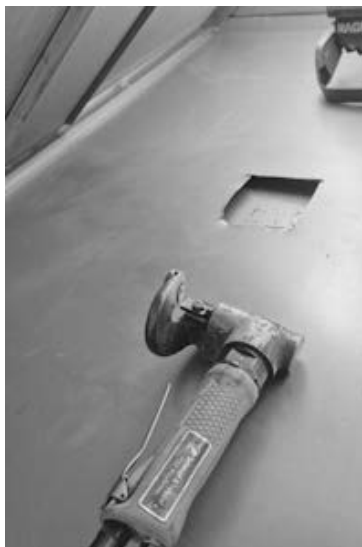
2. Klipp ut ett Ø200 mm hål i tråget
