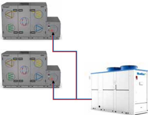
**Beispiel 2. Eine luftgekühlte Kältemaschine und eine Wärmepumpe produzieren Kälte und Wärme für ein System aus Klimabalken und erwärmt die Zuluft des GOLD-Gerätes.**
