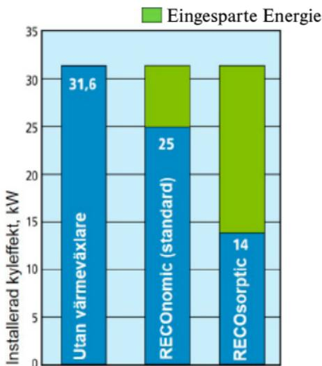
Das Beispiel im Diagramm zeigt die Kühlkapazität, die im Sommerbetrieb eingespart werden kann.
