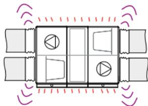
*Ventilatorgeräusche in GOLD werden nicht auf das Gehäuse übertragen, sondern in den Anschlusskanal abgeleitet und dort durch Schalldämpfer abgeschwächt (Abbildung links). In anderen Geräten werden Vibrationen von den Ventilatoren auf das Gehäuse und damit in die Umgebung übertragen.*
