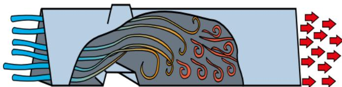
*RECOeconomic wird in einem patentierten Herstellungsverfahren gefertigt, bei dem kleine Rippen in den Luftkanälen entstehen. Die Rippen erzeugen einen turbulenten Luftstrom, der die Rückgewinnung optimiert.*
