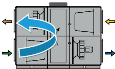
*Im Sommer wird die Feuchtigkeit aus der Außenluft zurückgewonnen und nach außen zurückgeleitet.*
