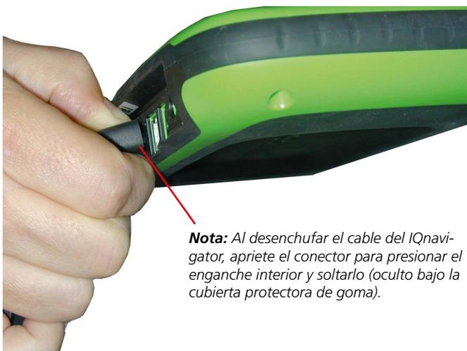
**Nota:** Al desenchufar el cable del IQnavigator, apriete el conector para presionar el enganche interior y soltarlo (oculto bajo la cubierta protectora de goma).
