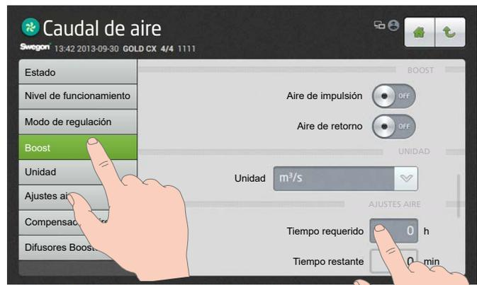
Si se muestra el botón On/Off en la pantalla táctil, arrástrelo o tóquelo de modo que aparezca en la posición correcta.
