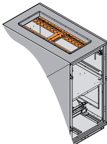
Fixer les plaques d'équilibrage au plafond par l'intérieur de la CTA à l'aide des vis autoforeuses.
