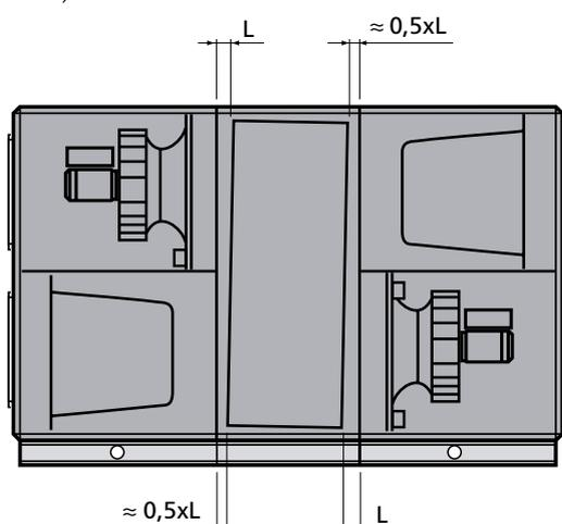
*GOLD RX, tailles 050-120: L'illustration montre l'inclinaison de la roue d'une configuration ventilateur 1 à la sortie d'usine. Elle est toujours orientée vers le filtre, ce qui signifie que pour une configuration ventilateur 2, l'inclinaison est dans l'autre direction.*
