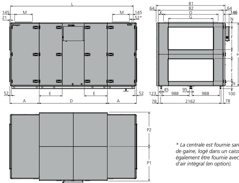
\* La centrale est fournie sans panneau de raccordement si un accessoire de gaine, logé dans un caisson isolé, doit être connecté. La centrale peut également être fournie avec un panneau de raccordement à passage d'air intégral (en option).
