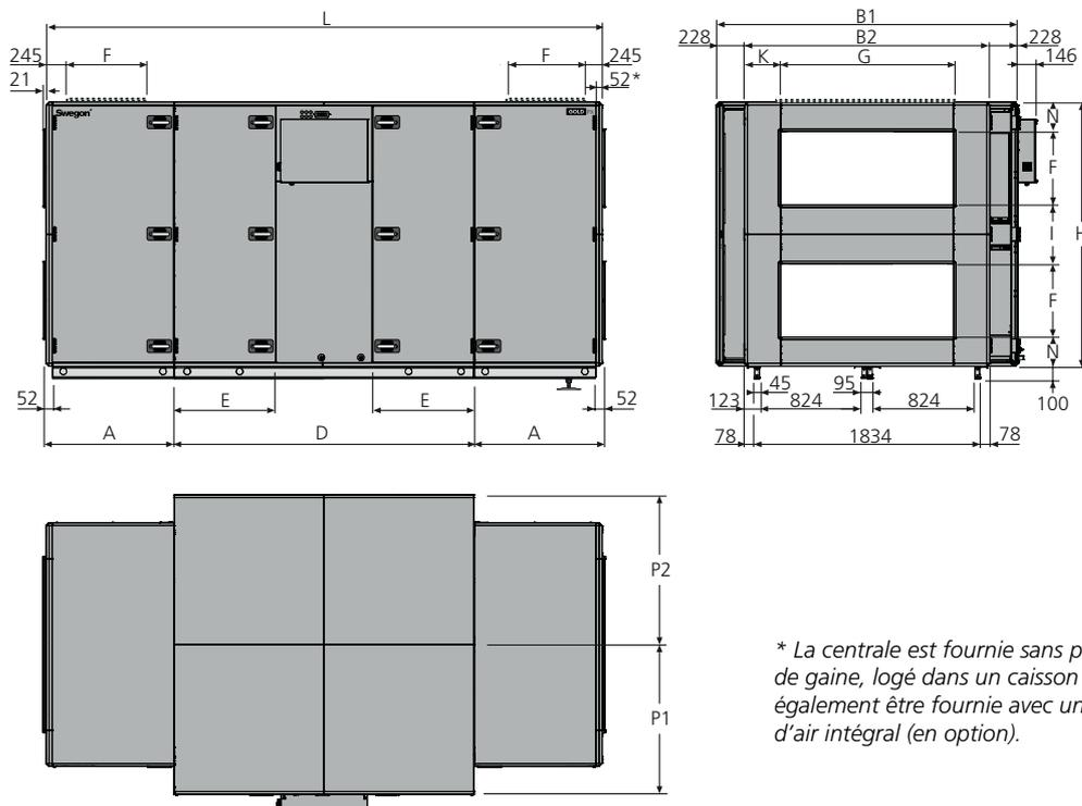
\* La centrale est fournie sans panneau de raccordement si un accessoire de gaine, logé dans un caisson isolé, doit être connecté. La centrale peut également être fournie avec un panneau de raccordement à passage d'air intégral (en option).
