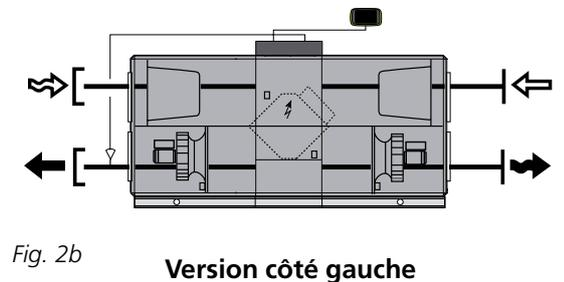
Les centrales sont livrées en version droite ou gauche selon Fig. 2a et 2b. Dans le cas de la version gauche (figure 2b), les pièces marquées d'un astérisque (\*) changent de fonction et de désignation (air soufflé ou air extrait).
