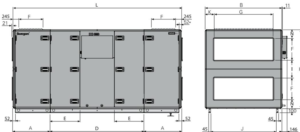
\* La CTA est fournie sans panneau d'extrémité lorsqu'un accessoire en caisson isolé est prévu. La CTA peut également être fournie avec panneau de raccordement à passage d'air intégral (en option).
