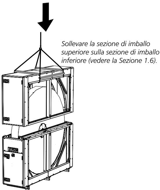
*Sollevare la sezione di imballo superiore sulla sezione di imballo inferiore (vedere la Sezione 1.6).*
