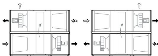
*Ventilatore dell'aria di mandata, destro, livello inferiore*     *Ventilatore dell'aria di mandata, destro, livello superiore*
