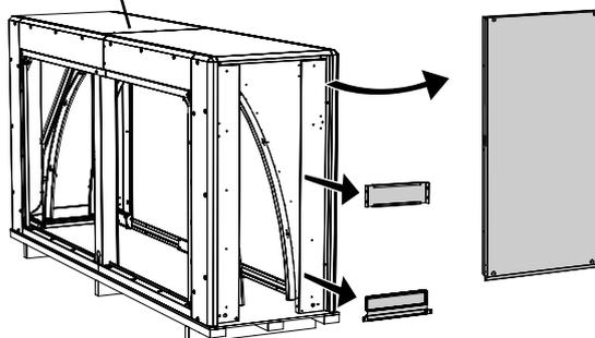
Rimuovere il pannello di copertura sul lato posteriore. Rimuovere le piastre di tenuta (2 pz).
