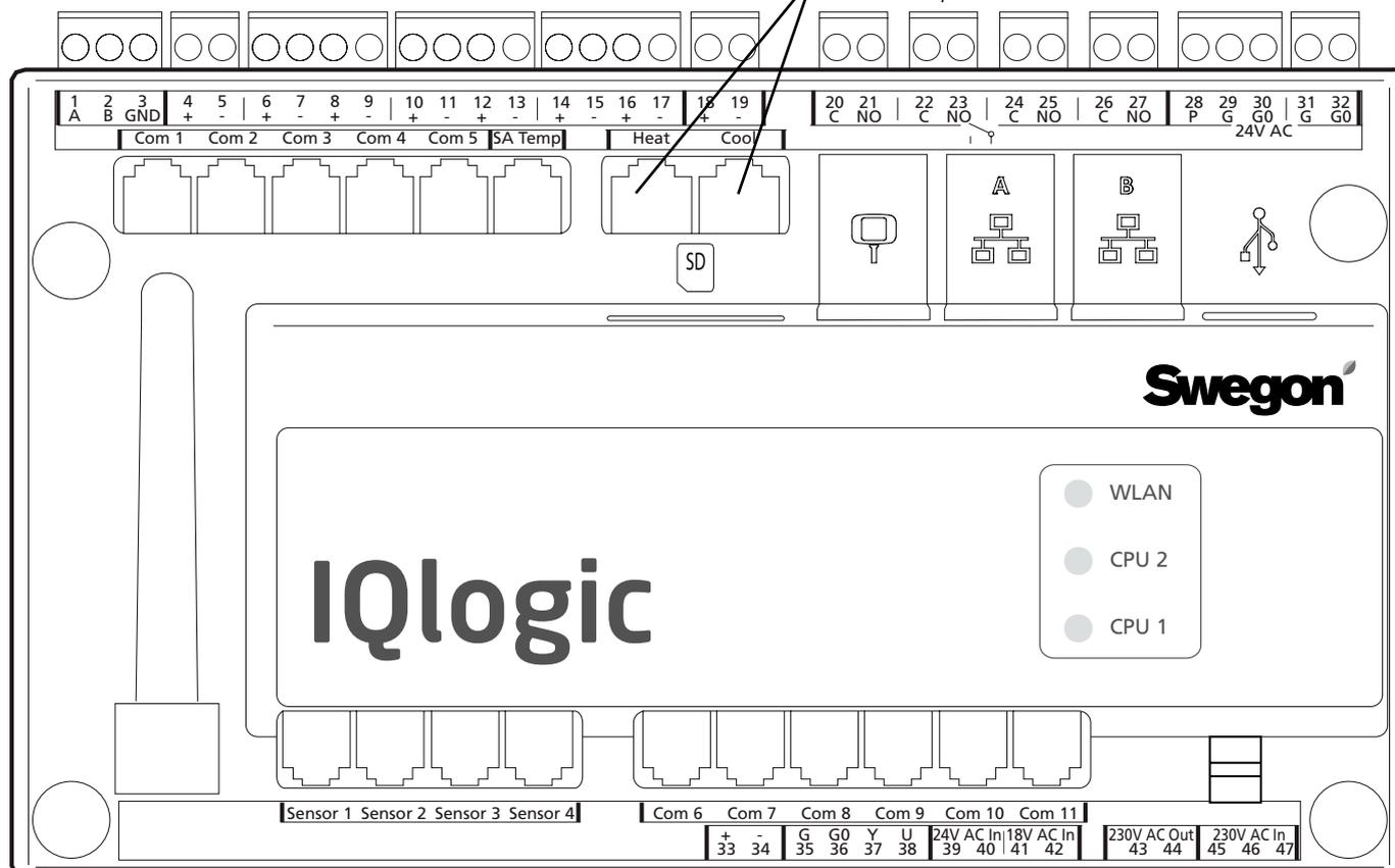
Gli ingressi digitali, morsetti 4-17, sono di tipo a bassissima tensione. Gli ingressi analogici, morsetti 18-19, hanno un'impedenza di ingresso di 66 kΩ.
