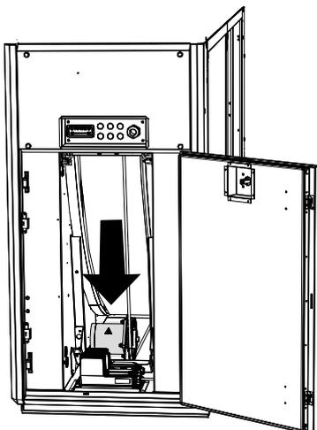
Allentare le due viti di fissaggio del motore + la staffa di montaggio. Spostare il motore + la staffa di montaggio nella posizione mostrata nell'illustrazione. Fissare il motore + la staffa di montaggio con i bulloni (6 bulloni).
