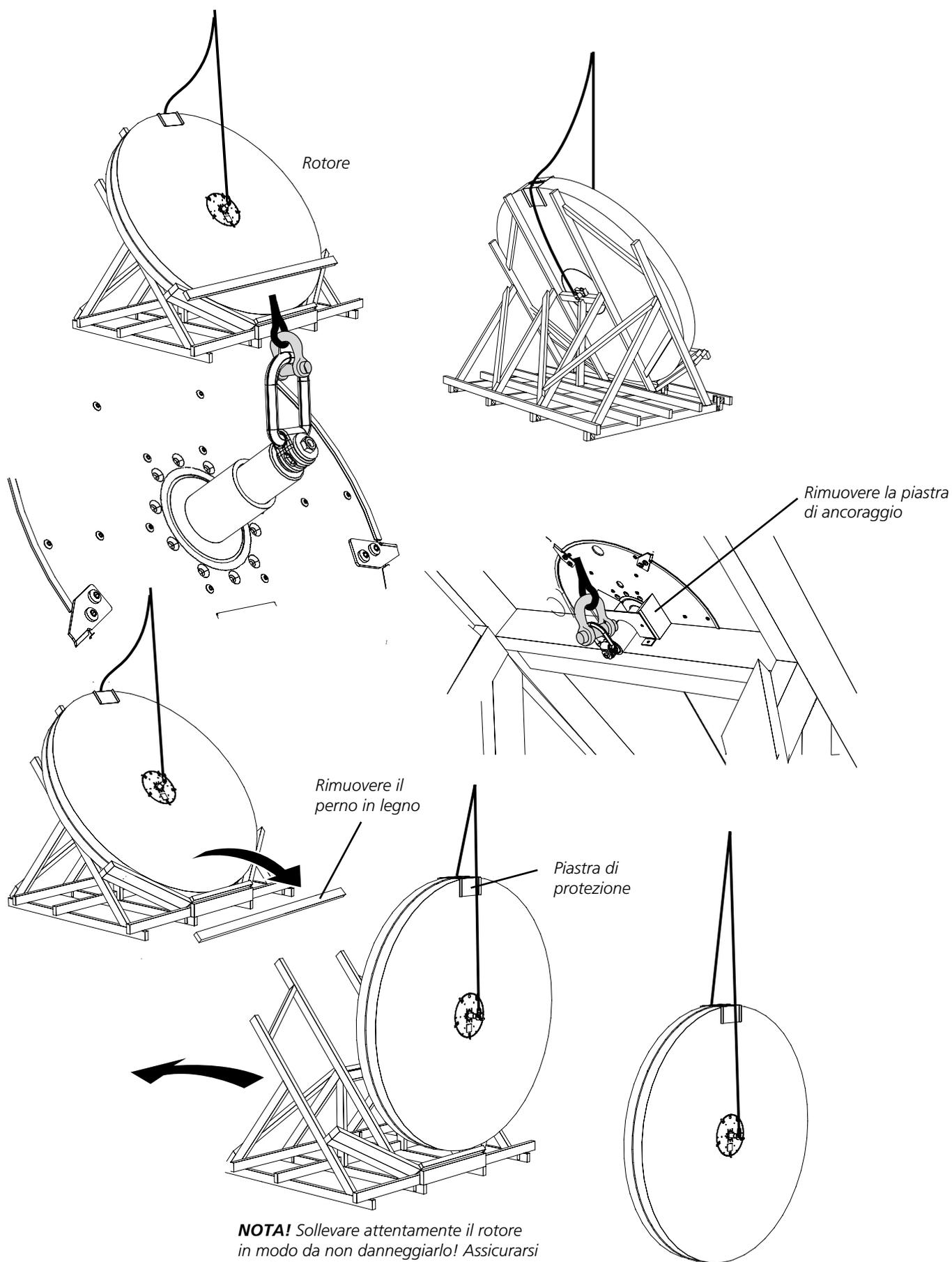
**NOTA!** Sollevare attentamente il rotore in modo da non danneggiarlo! Assicurarsi che il dispositivo di sollevamento appoggi contro la piastra di protezione nel bordo superiore.
