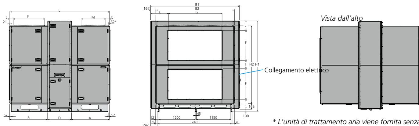
\* L'unità di trattamento aria viene fornita senza pannello di connessione terminale se verrà collegato un accessorio per canali collocato in un alloggiamento isolato. L'AHU può anche essere dotata di pannello di collegamento terminale full face (accessorio).
