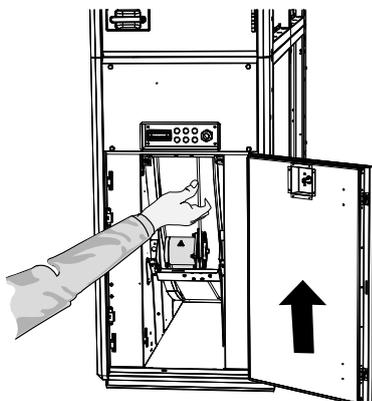
Allentare le due viti di fissaggio del motore + la staffa di montaggio. Ricollocare il motore + la staffa di montaggio nelle relative posizioni originali. Fissare il motore + la staffa di montaggio con i bulloni (6 bulloni).
