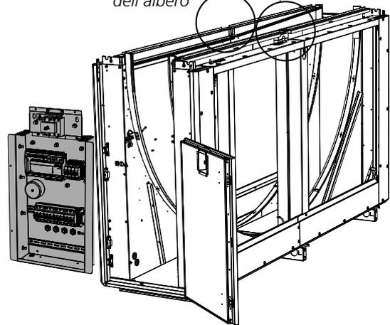
Smontare il motore dello scambiatore di calore + la staffa di montaggio (6 bulloni). Smontare il regolatore del rotore, la piastra di tenuta, i pannelli e il tubo flessibile.
