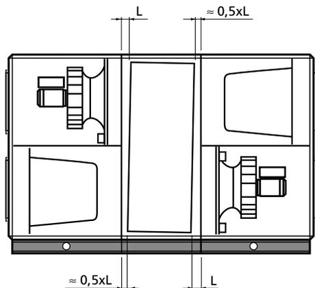
*L'illustrazione mostra un'impostazione di inclinazione appropriata del rotore per la disposizione 1 dei ventilatori. L'inclinazione deve sempre essere verso il filtro, il che significa che l'inclinazione per la disposizione dei ventilatori 2 è nell'altra direzione.*
