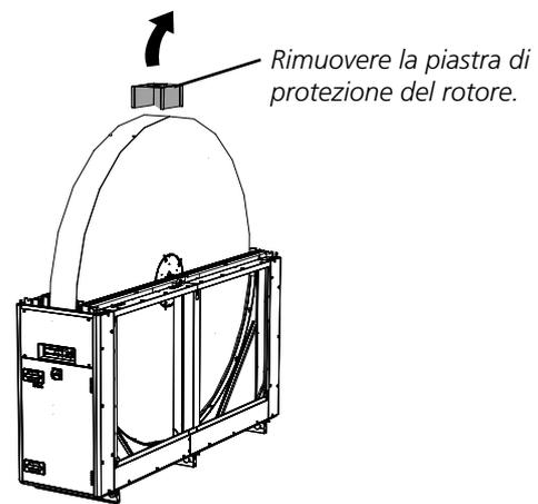
*Rimuovere la piastra di protezione del rotore.*
