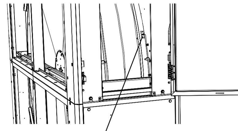
*Far scorrere la guarnizione in tessuto rivestita in vinile del rotore (blu) sopra all'orlo tutto intorno a entrambi i lati del rotore.*
