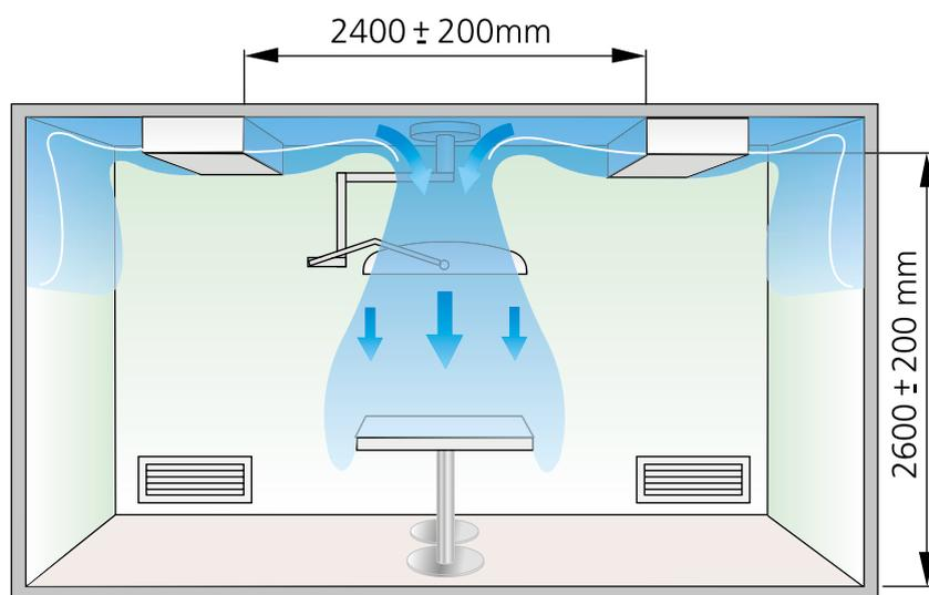
Figure 2. Exemple d'installation pour performances optimales.
