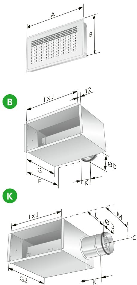
Figure 4. Dimensions, LOCKZONE Wall et plénum d'équilibrage ALV.
