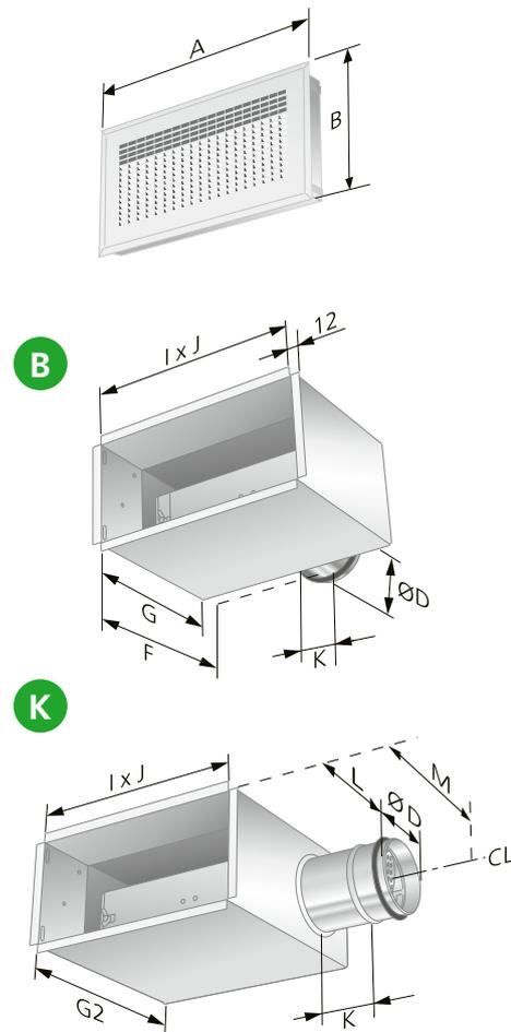
Abb. 4. Abmessungen, LOCKZONE Wall und Anschlusskasten ALV.
