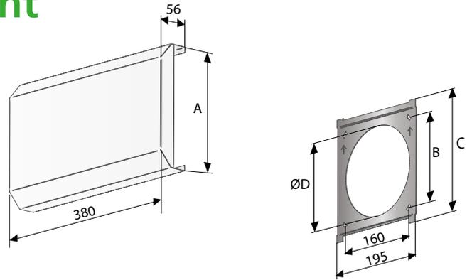
Abb. 3. SOTTO, Abmessungen.
