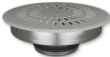
Der Befestigungsrahmen wird an der Unterlage mit Schrauben an der Rahmenkante befestigt. Der Luftauslass wird oben auf den Befestigungsrahmen platziert und mit der Schraube in der Mitte festgeschraubt. Wenn der Anschlusskasten ALS verwendet wird, muss dieser in der Gebäudekonstruktion fixiert werden, siehe Abbildung 1.
