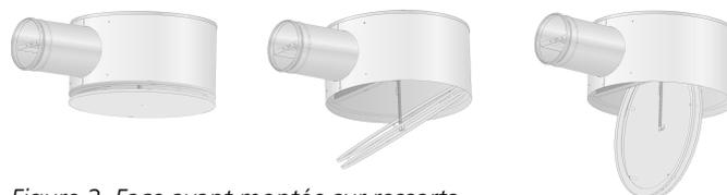
Figure 2. Face avant montée sur ressorts.
