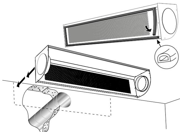
Figure 2a. IBIS W, connexion par l'arrière. Application du joint d'étanchéité.
