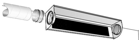
Figure 3a. IBIS W, connexion latérale. Application du joint d'étanchéité, voir figure 2a.
