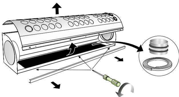
Figure 1. IBIS W, démontage de la plaque avant.
