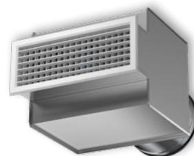
tion et le fixer à la structure du bâtiment à l'aide de consoles ou de tiges de suspension. Repousser le cadre télescopique dans le plénum depuis le local et fixer sur les côtés à l'aide de rivets. Enfoncer ensuite la grille dans le contre-cadre. Si la somme de la largeur et de la hauteur de la grille dépasse 700 mm, fixer la grille dans le mur au moyen des percements prévus pour des vis à tête fraisée. Voir Figure 1.
